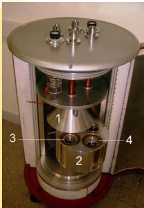
Figure 3 : Calorimètre à fluxmètre thermique du type Tian-Calvet (1965). Cette maquette ouverte laisse voir, sous le cône équirépartiteur de température (1), le cylindre central (2) du thermostat dont on voit deux des quatre thermopiles (3 et 4) qui possèdent environ un millier de jonctions chromel-alumel chacune.
