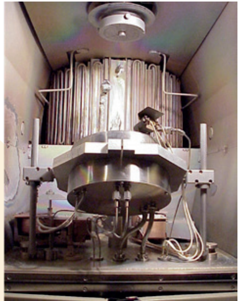
Figure 3 : Schéma de principe (à gauche) du procédé d'évaporation par canon à électrons assistée par faisceau d'ions (IAD, Ion Assisted Deposition ), et photographie (à droite) de l'intérieur d'une machine fonctionnant sur ce principe à l'Institut Fresnel-1983. Photo ©Institut Fresnel
