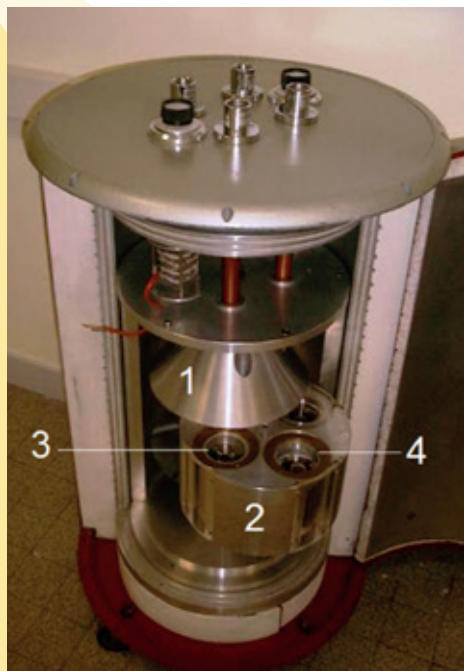
Figure 3 : Calorimètre à fluxmètre thermique du type Tian-Calvet. Cette maquette ouverte laisse voir, sous le cône équirépartiteur de température (1), le cylindre central (2) du thermostat dont on voit deux des quatre thermopiles (3 et 4) qui possèdent environ un millier de jonctions chromel-alumel chacune.
